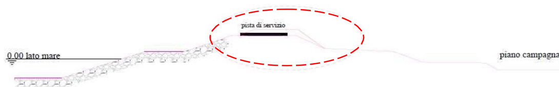
Figura 17. Sezione tipo argine fluviale, esempio 1. Ringrossi senza nuova occupazione arginale
